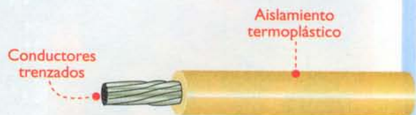
Figura 3.2. Estructura básica del cable trenzado
